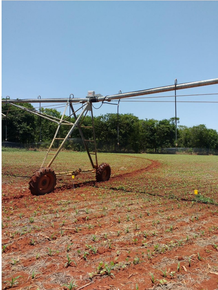
Figura 31. Coletor deslocado do caminho de torre de deslocamento de pivô central (foto em aula da disciplina Irrigação e Drenagem/Engenharia Agrônômica/UFSJ, fazenda na região de Sete Lagoas, MG, 2019).
