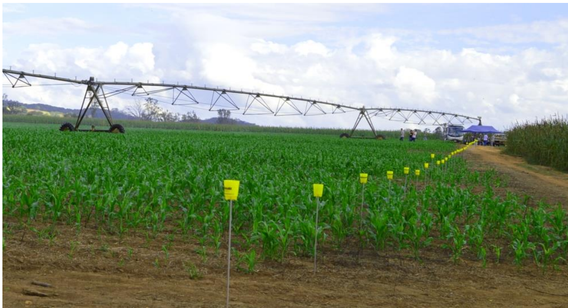
Figura 29. Disposição de coletores no campo para determinação da uniformidade de distribuição de água em pivô central (foto de Adriane Duarte Coelho em aula da disciplina Irrigação e Drenagem/Engenharia Agrônômica/UFSJ, na Embrapa Milho e Sorgo, 2016).
