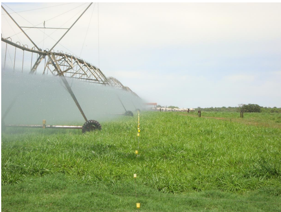
Figura 30. Disposição de coletores no campo para determinação da uniformidade de distribuição de água em pivô central (foto em aula da disciplina Irrigação e Drenagem/Engenharia Agrônômica/UFSJ, fazenda na região de Sete Lagoas, MG, 2014).
